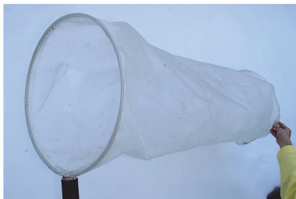
図 1 特製のタモ網型の杵取り採取具(直径 40 cm、奥行き 120 cm、杵面積 0.125 m<sup>2</sup>)。
